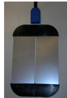
L'uso di un connettore plastico (sia per l'elettrodo che per la placca di ritorno) è necessario per garantire le distanze di isolamento tra i cavi di segnale e lo schermo.
